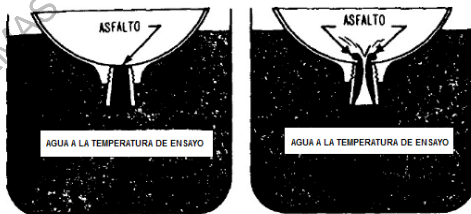
Figura 711 - 4. Irrupción del agua dentro del flotador
